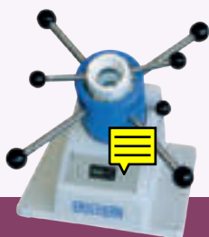
TEST ERICHSEN D'EMBOUTISSAGE ISO 1520 Totale résistance à la déformation Opérations de pliage, cambrage possibles après traitement.
