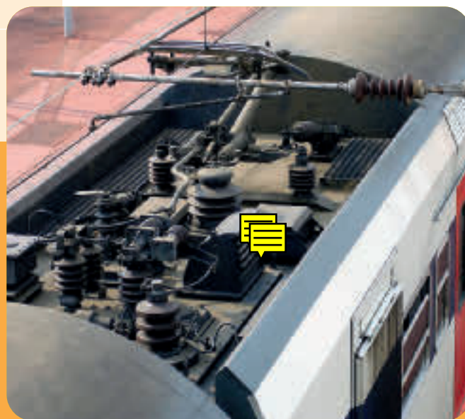
Lubrification dynamique, sous HT, de pantographes.
